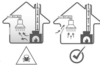
Bei zu geringer Luftzufuhr entsteht ein Unterdruck. Giftige Gase aus dem Schornstein oder dem Auspuffrohr werden in die Räume des Hauses zurückgeführt.
