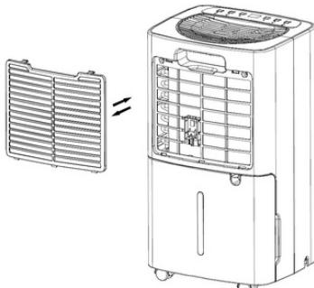
2.Coloque el filtro T-CLEAN en el marco del filtro para un montaje correcto.
