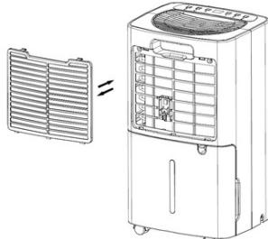
2.2. Posizionare il filtro T-CLEAN nel telaio del filtro per un montaggio corretto. (Non dimenticare di rimuovere l'imballaggio in plastica del filtro T-CLEAN prima del montaggio e dell'utilizzo).
