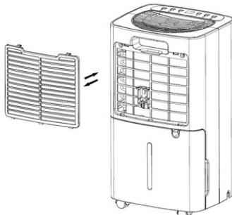
b) Folosiți un aspirator pentru a îndepărta ușor praful de pe suprafața filtrului. Dacă filtrul este foarte murdar, spălați-l cu apă și cu detergent și uscați-l bine după aceea.
