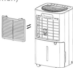
2. Setzen Sie den HEPA-T-CLEAN Filter zur korrekten Befestigung in den Filterrahmen ein. (Vergessen Sie nicht, die Kunststoffverpackung des T-CLEAN- Filters vor der Montage und Verwendung zu entfernen).
