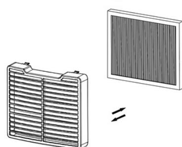
3. Montez le filtre T-CLEAN avec le cadre sur l'appareil
