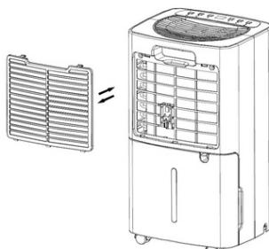
2. Puneți filtrul HEPA T-CLEAN în rama filtrului pentru montajul corect al acestuia. (Nu uitați să scoateți ambalajul de plastic al filtrului T-CLEAN nainte de montaj și utilizare).
