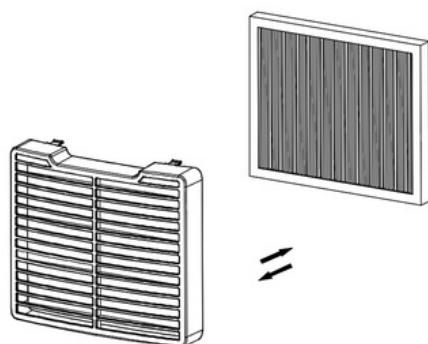
3. Montare il filtro T-CLEAN con il telaio sull'unità
