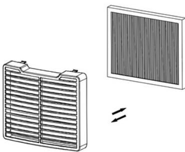
3. Montați pe unitate filtrul T-CLEAN cu rama
